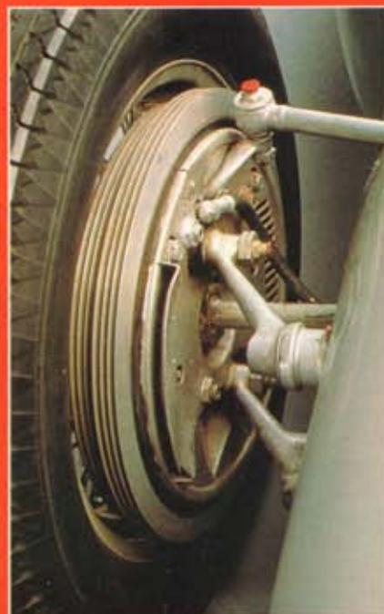
An den vorderen Bremsen sorgten an den Außenrändern Verrippungen für Kühlung
