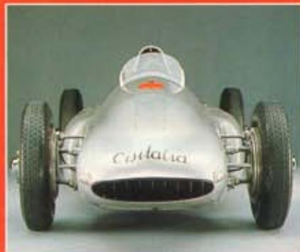
Heißer Hai: Die Öffnung im Bug diente der Frischluftzufuhr des Öl- und Wasserkühlers
