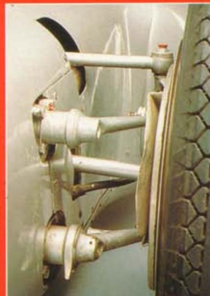
Beim Einfedern bleiben die Räder der Vorderachse ohne Sturz- und Spurveränderung
